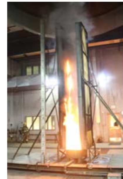
SAB-Sandwichpaneelle im Paralleltest von FM-Global
